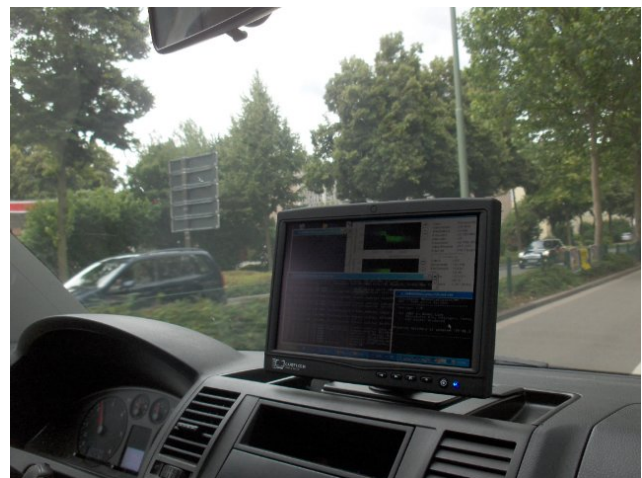
Abb. 12.4.: Messbus der FH-KL, Innenansicht. Links: Arbeitsbereich mit aktivem Messsystem; Rechts: Fahrerkabine mit Überwachungsbildschirm des DRM + -Dekoders.
