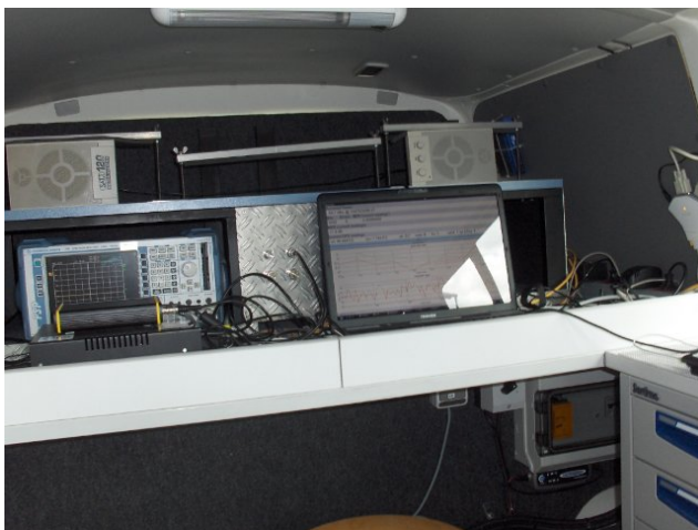
Abb. 12.4.: Messbus der FH-KL, Innenansicht. Links: Arbeitsbereich mit aktivem Messsystem; Rechts: Fahrerkabine mit Überwachungsbildschirm des DRM + -Dekoders.
